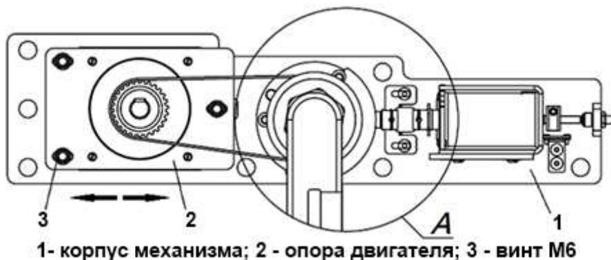
Рисунок 10 – Натяжение зубчатого ремня
